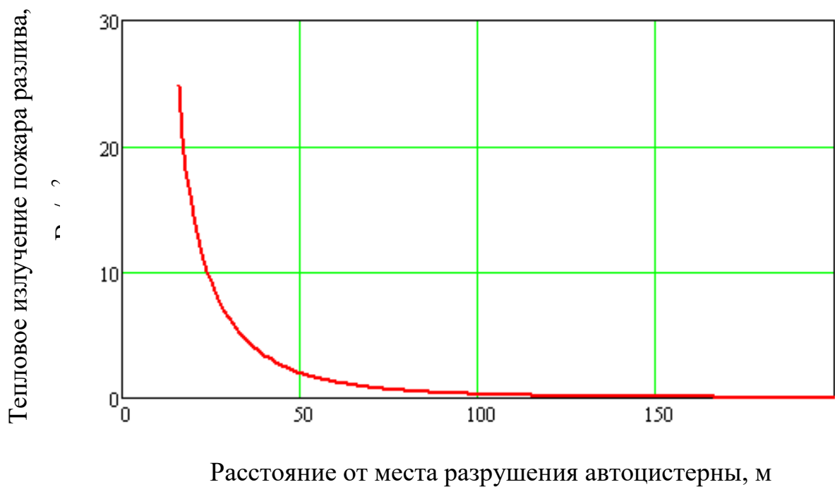
Рисунок 15 – Зависимость величины теплового излучения пожара разлива от расстояния.
